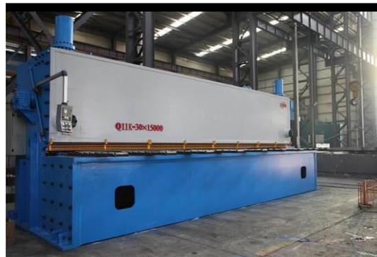
15m 超大型数控剪板机电液控制系统
