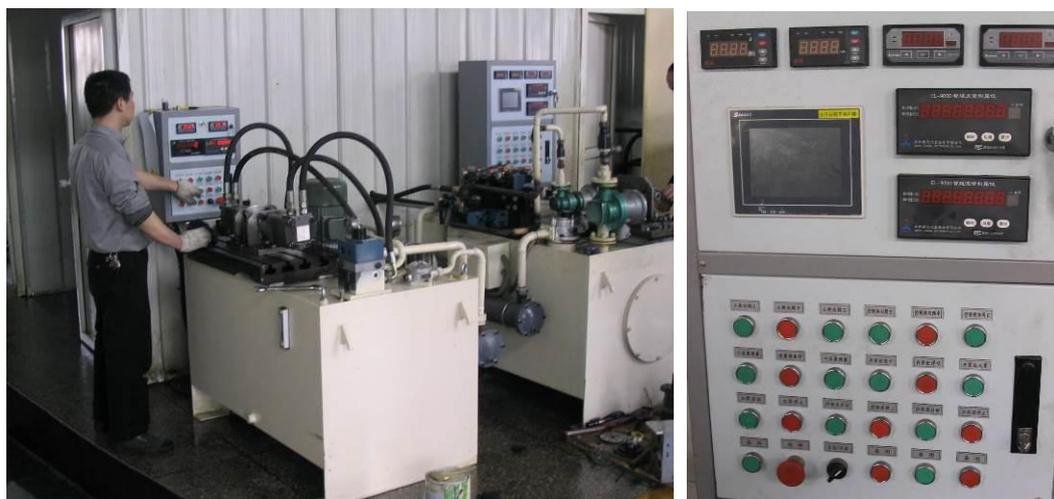
液压马达及特种液压阀计算机测控试验台
