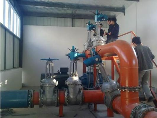
船用高速透气阀试验系统
