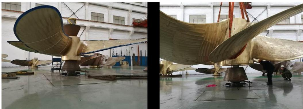
螺旋桨高精度液压静平衡智能检测系统
