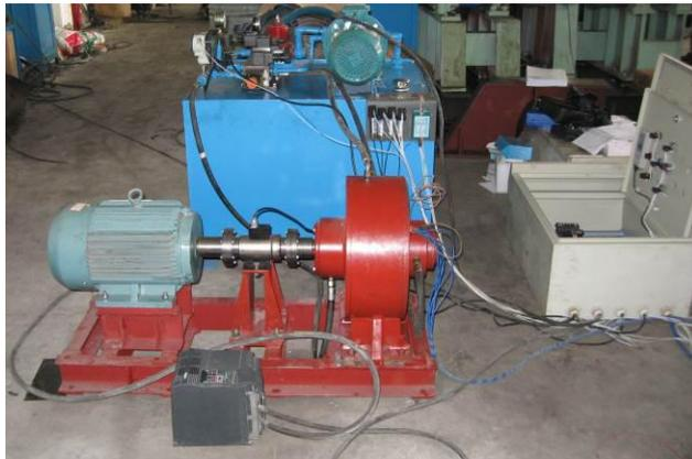
液粘/磁流变液调速离合器试验台
